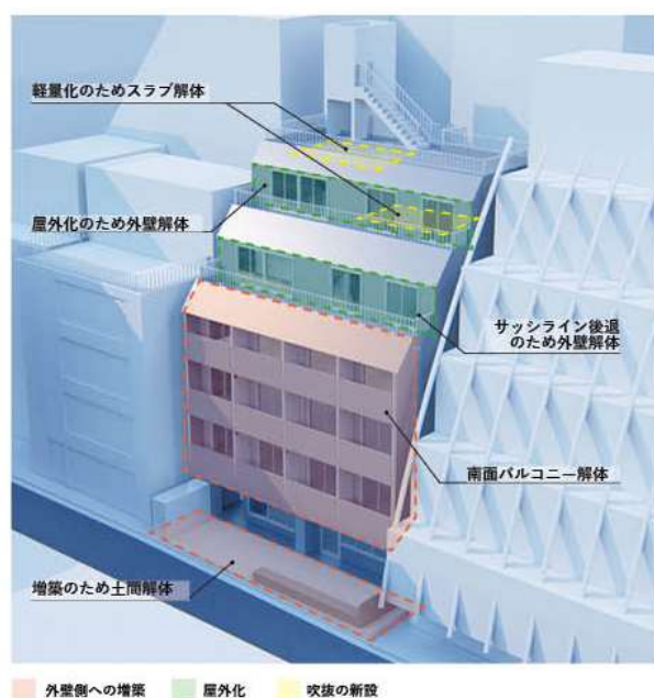
工事前/既存建物解体概要
