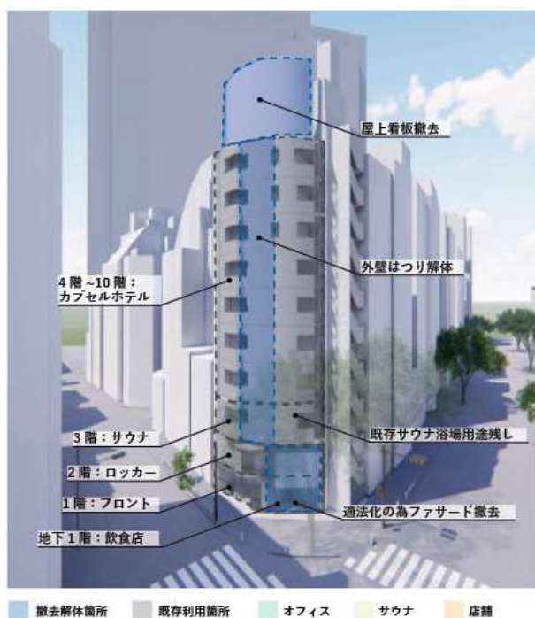
工事前/既存建物解体概要
